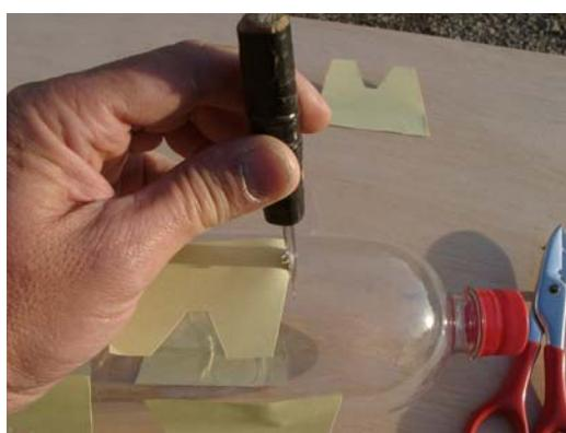
Perforer ensuite au cutter en suivant le papier, une paire de ciseaux (moins dangereuse) prendra rapidement le relais pour finir la découpe de l'ailette, marquer le pli et faites la suivante en se guidant sur les papiers qui sont retirés ensuite. Un peu de peinture pour la finition et c'est prêt à tourner. A vous d'imaginer formes et couleurs...
